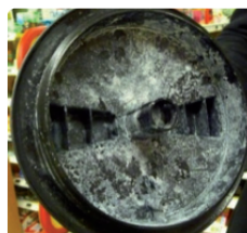
Réservoir d'eau de l'autolaveuse après utilisation des produits habituels : dépôts et mauvaises odeurs associées
